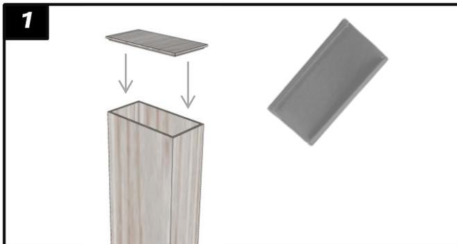
1 ตัด ALU-X ด้วย เครื่องตัดโดยใช้ใบตัดอลูมิเนียม ให้ได้ตามขนาด ปิดหัวท้ายแผ่นด้วย SCG ALU-X Endcap เก็บงานแล้วติดตั้งด้วย Modify Silicone SR-S90
