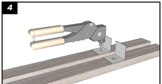
4 ยึดจากอลูมิเนียมเข้ากับแผ่น ALU-x ด้วยตะปูเรียวท 4-4 หรือตะปูเกลียวสแตนเลสหัวร่วม SUS PH 8x1/2 ตรงตำแหน่งที่วัดไว้
