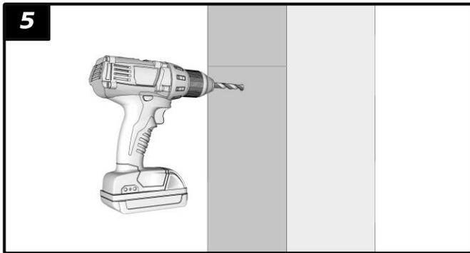
5 เจาะรูผนังตรงจุดที่มาร์คตำแหน่งไว้ ด้วยส่วนโรตารีดอกเจาะคอนกรีต ขนาด 8 mm.
