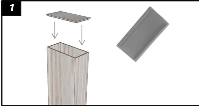
1 ตัด ALU-X ด้วย เครื่องตัดโดยใช้ใบตัดอลูมิเนียม ให้ได้ตามขนาด ปิดหัวท้ายแผ่นด้วย SCG ALU-X Endcap เก็บงานแล้วติดตั้งด้วย กาวโมดิไฟยด์ ซิลิโคน SR-S90
