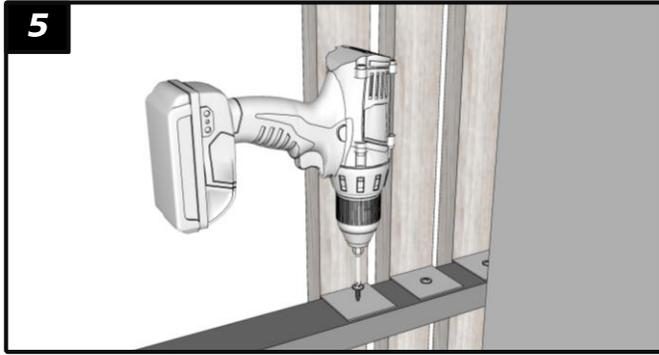
นำแผ่น Alu-X ที่ตัดจากแล้วหนึ่งด้านมายึดเข้ากับโครงคร่าว โดยใช้ระดับน้ำเชิกให้แผ่นตั้งตรงและได้ระนาบ แล้วยึดด้วยตะปูเกลียวปลายสว่าน เอสซีจี ยาว 13 มม. เข้ากับโครงคร่าว
