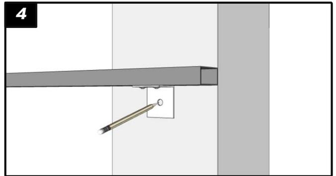
4 ยกโครงเหล็กเข้ากับเสาคอนกรีตตามแนวเส้นระดับเพื่อมาร์คจุด สำหรับเจาะรูเพื่อฝังพุกเหล็ก
