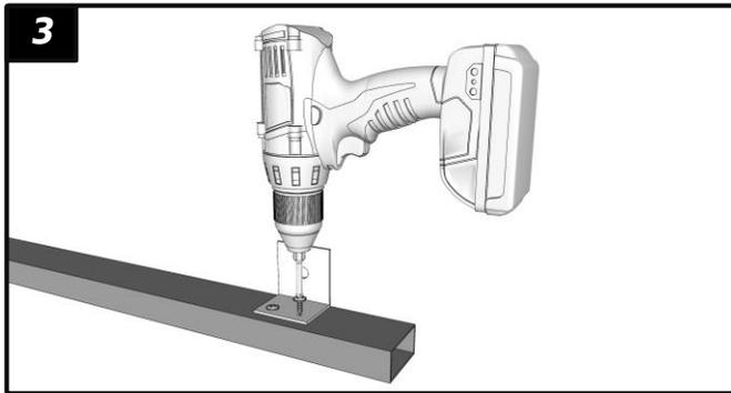
3 ยึดโครงเหล็กกล่อง 1"x2"x2.3 มม.\* เข้ากับเสาคอนกรีตด้วยเหล็กฉาก 2"x2" หน้า 3 มม. โดยด้านที่เหล็กฉากยึดกับโครงคร่าวให้ใช้ตะปูเกลียวปลายส่วน เอสซีจี ยาว 13 มม./เชื่อมเหล็ก
