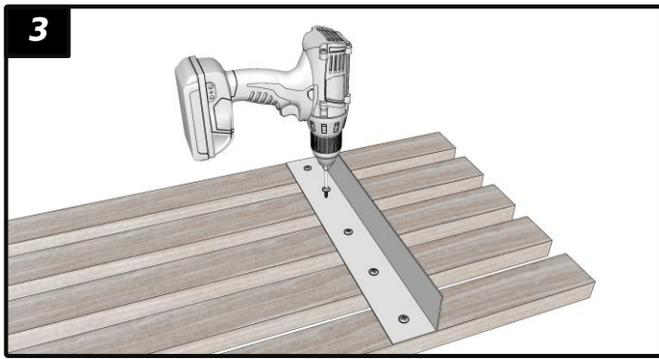
3 ยึดจากอลูมิเนียมเข้ากับแผ่น ALU-x ด้วยตะปูเรียวท 4-4 หรือตะปูเกลียวสแตนเลสหัวร่วม SUS PH 8x1/2 ตรงตำแหน่งที่วัดไว้
