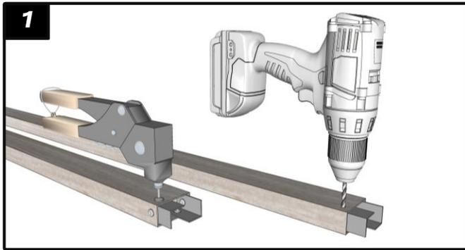
ตัดฉากอลูมิเนียม ขนาด 25x25 มม. ยาว 40 มม. 2 ชิ้น ยึดเข้ากับแผ่น Alu-X ด้วยตะปู รัวทก 4-4 ด้านละ 2 ตัว ดังแสดงในภาพ
